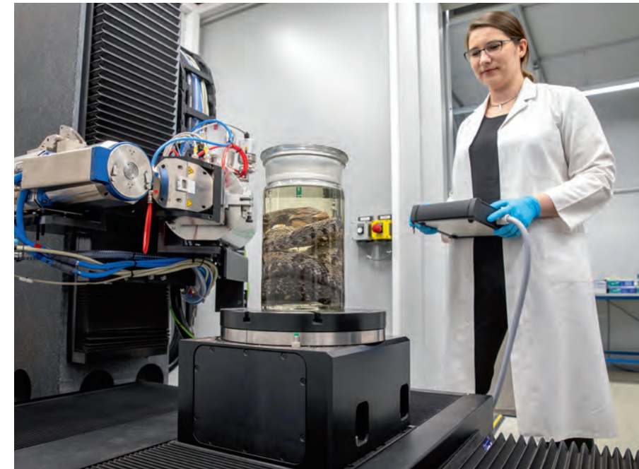
Kristin Mahlow justiert das Objekt im neuen, 30 Tonnen schweren CT-Scanner
